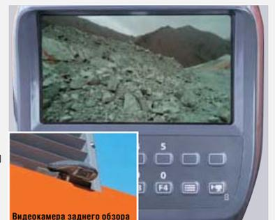
Видеокамера заднего обзора
