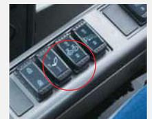
Переключатель системы автоматизированной смазки
